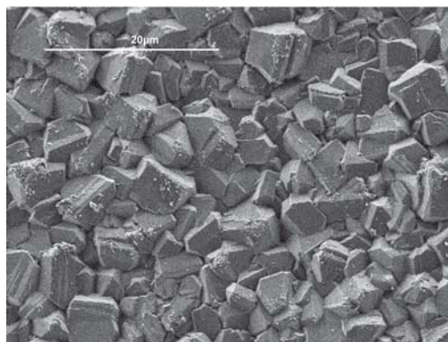
2. ábra. Egy tömítés Burgmann DiamondFaces® gyémántbevonatú csúszófelülete
