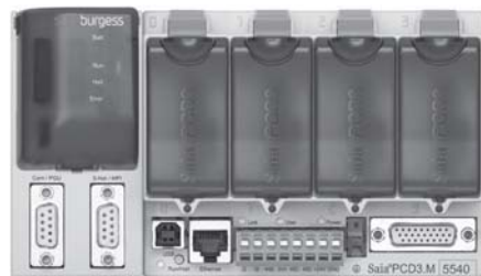
Korszerű, WEB technológiát is alkalmazó Saia PCD-vezérlő
